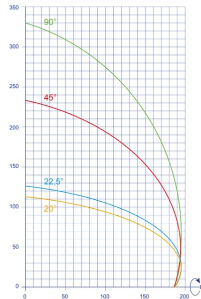
40 MP ist eine Einkopf-Säge von oben kommend, mit Sägeblatt  $\varnothing$  400 mm. Die Profilauflegefläche kann manuell in einem Winkel von +/- 45° verstellt werden. Die Neigung des Sägekopfes kann manuell von 0° bis 45° nach außen erfolgen. Die Einkopfsäge 40MP ist mit horizontalen Spannzylindern für das korrekte Einspannen des Profils, Minimal-Sprühung und mechanischem Schutz des Sägebereichs ausgestattet.
